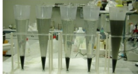
Prove di sedimentazione con vari flocculanti
